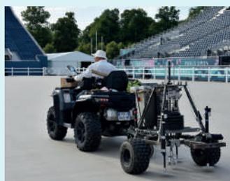
Avant les jeux, dans le parc du château de Versailles, un ingénieur teste la qualité du sol du terrain d'Honneur des épreuves d'équitation à l'aide de l'Equine Track Tester (ET2), un appareil innovant développé par les chercheurs de l'unité BPLC d'INRAE, en partenariat avec l'Ifce et l'EnvA. Doté de capteurs embarqués, l'ET2
