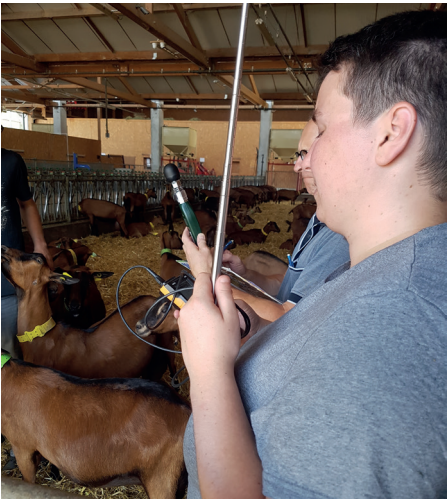
Prises de mesures de la température et de la vitesse de l'air dans la chèvrerie Patuchev. © Hugues Caillat - INRAE
