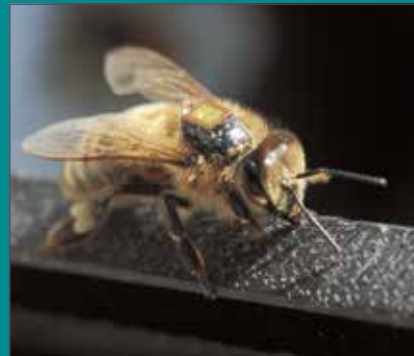
Micropuce RFID collée sur le thorax d'une abeille. © C. Maître, INRAE
