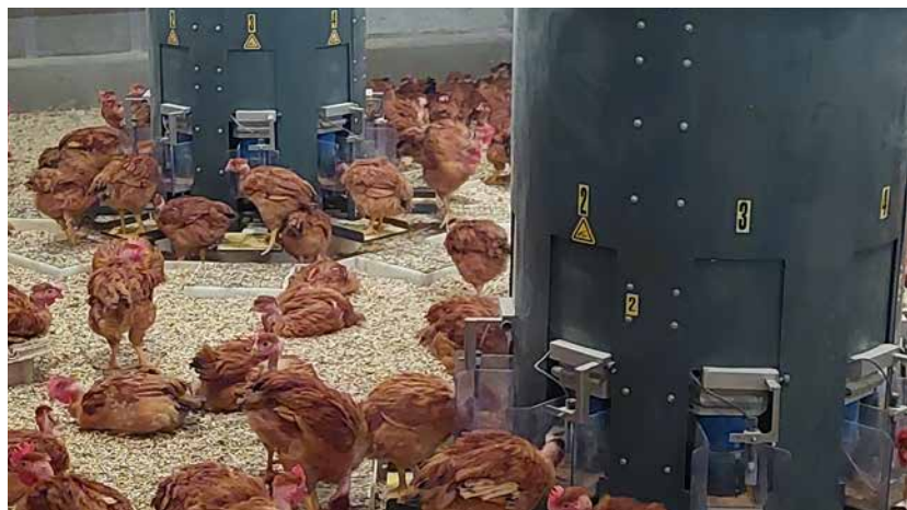
© UMR BOA/ INRAE Mesure automatisée, individuelle et sans contrainte du poids et de l'alimentation de volailles label rouge.
