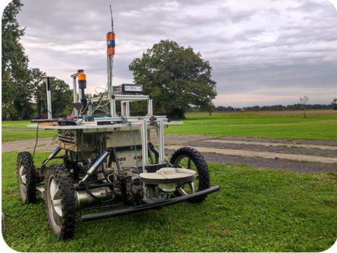
Capable d'atteindre 30 km/h et doté de capacités dynamiques importantes, Robufast a été développé dans le cadre du projet ANR FAST (2007-2011) pour concevoir les algorithmes de commandes à haute vitesse. Sa mission est d'aller le plus vite et le plus précisément possible. Il est également exploité pour tester les briques de sécurité.
