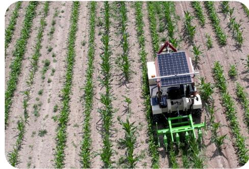
Ces véhicules électriques robotisables exploitent des résultats d'algorithmes de coopération entre robots mobiles dans un contexte agroécologique. Ils évoluent de façon coordonnée pour minimiser le temps de traitement des parcelles. Les modalités de perception et de commande s'adaptent à la tâche et au terrain.
