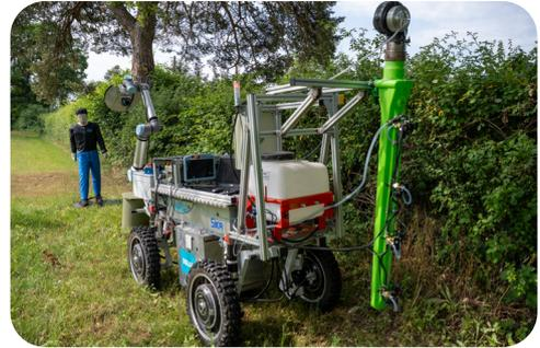
Cette démonstration illustre les protocoles de tests de sécurité en cours de développement. Ils visent à évaluer la sécurité des robots, ici illustrée par l'évitement de collision. Le robot RobuFAST d'INRAE est utilisé pour éprouver les procédures de qualification en cours de développement, en lien notamment avec l'OCDE.
