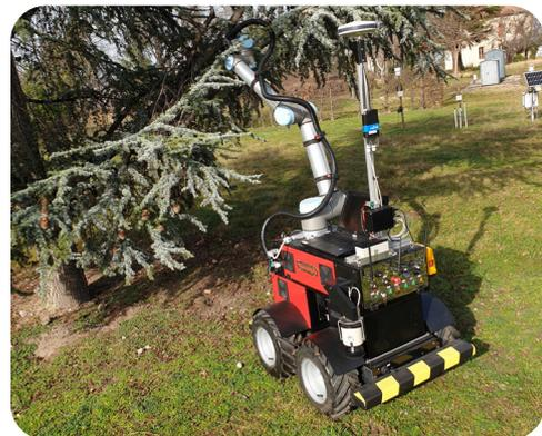
Ce robot à pilotage différentiel permet de développer les travaux de recherche sur la manipulation mobile en milieu naturel. Ses capacités de rotation à vitesse nulle permettent d'étudier la coordination des mobilités du bras et de la plateforme. D'autres recherches sont menées sur ce robot pour la manipulation d'objets déformables.
