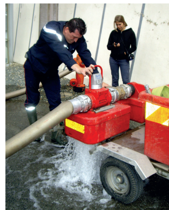
Essai d'un poteau incendie (source : Irstea)
