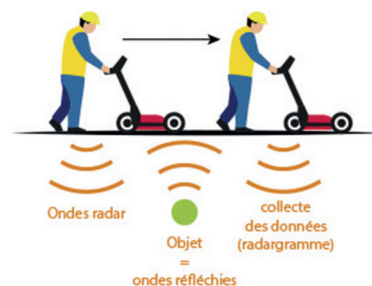
Principe de la géodétection (source : I.D.R.S)
