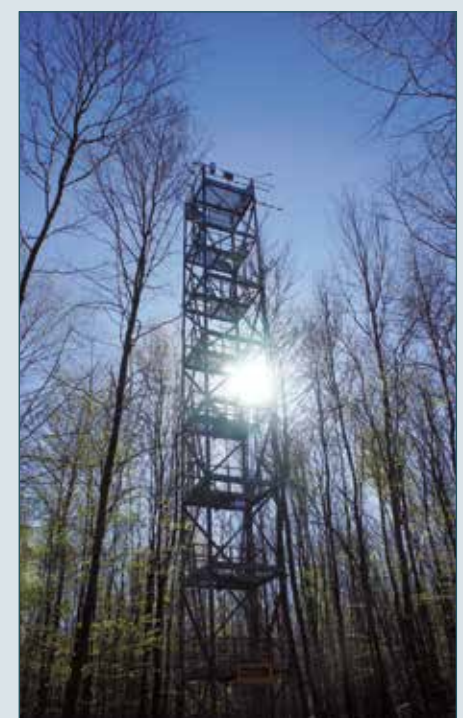
Sur le site ICOS de Hesse, cette tour de 35 mètres mesure en continu les échanges gazeux (CO 2 gaz à effet de serre...) entre la forêt et l'atmosphère.
