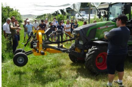
Démonstration de désherbage mécanique du rang en verger – EPLEFPA Montauban
