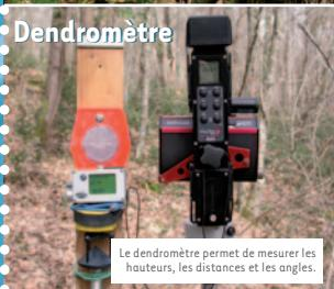
Le dendromètre permet de mesurer les hauteurs, les distances et les angles.
