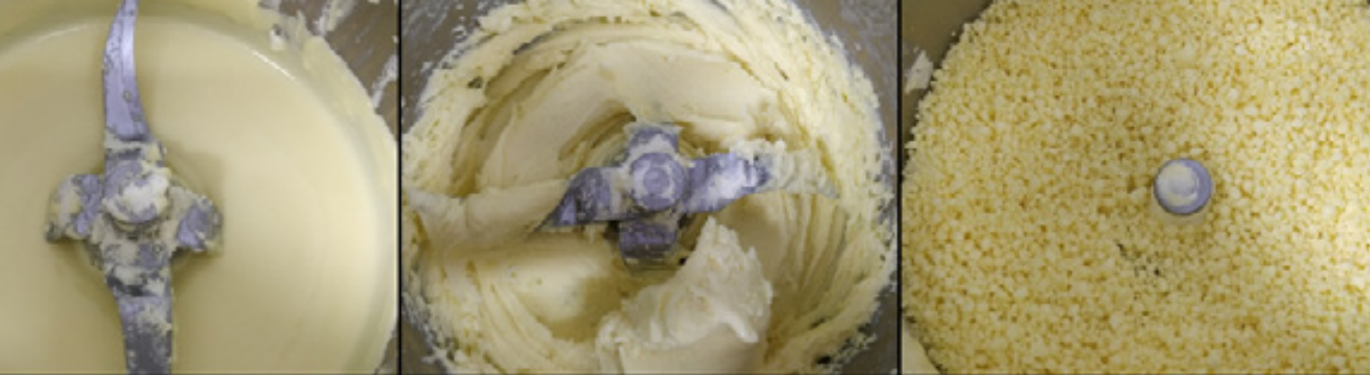
© Maheshchandra Patil - Surconcentration-granulation de perméat de lactosérum à l'échelle du laboratoire: concentré visqueux, surconcentré hautement cohésif et granules
