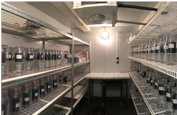
Chambre d'incubation des sols avec résidus en conditions contrôlées, et dispositif automatisé de mesures du CO_2 et N_2O émis © G. Lashermes - INRAE FARE & P. Laville - INRAE ECOSYS
