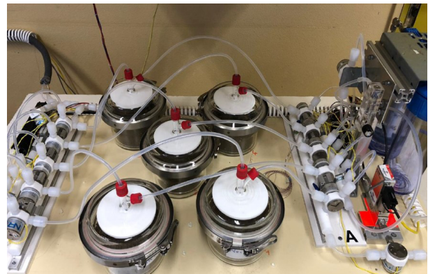
Chambre d'incubation des sols avec résidus en conditions contrôlées, et dispositif automatisé de mesures du CO_2 et N_2O émis © G. Lashermes - INRAE FARE & P. Laville - INRAE ECOSYS
