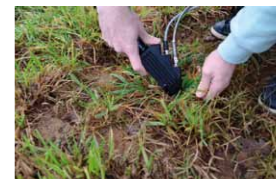
Mesure de spectres d'absorption dans le proche infra-rouge sur herbe verte à l'aide du spectromètre LabSpec4 portable.
